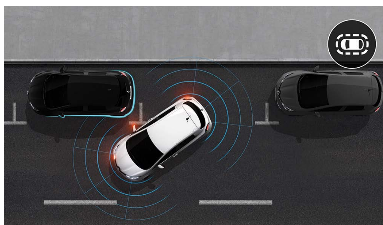
parkeersensoren vóór en achter Parkeersensoren vergemakkelijken jouw manoeuvres door je te waarschuwen met geluids- en visuele signalen over de nabijheid van obstakels voor en achter je.
